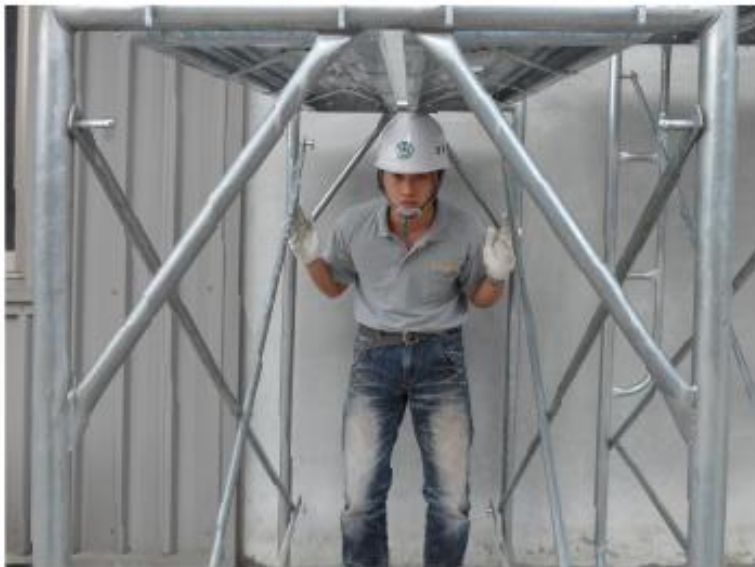
寬度762型-高度1725mm 簡易型施工架
