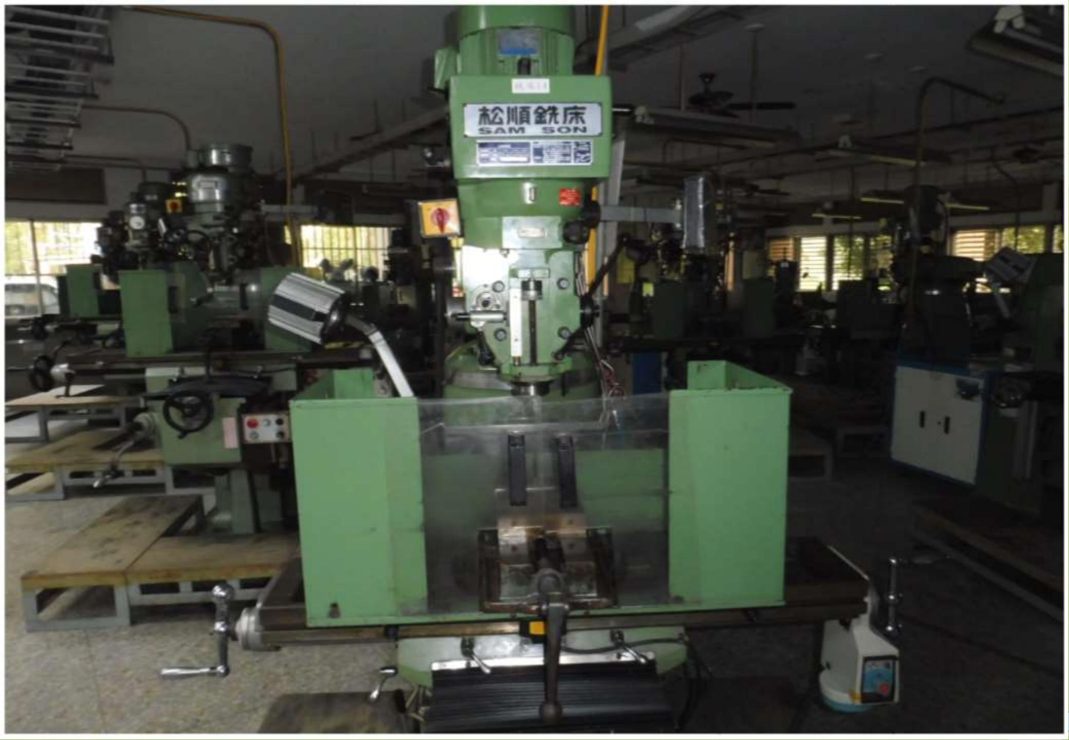
鑽孔機等旋轉刀具作業，未明確告知並標示勞工不得使用手套。
