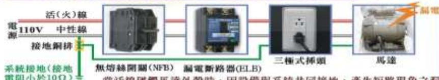
當活線碰觸馬達外殼時，因設備與系統共同接地，產生短路現象之漏電電流，使漏電斷路器(ELB)於0.1秒內動作斷電，馬達外殼不帶電。
