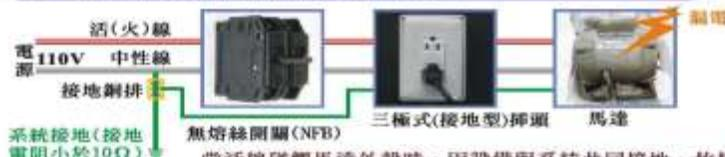
當活線碰觸馬達外殼時，因設備與系統共同接地，故相當於短路現象，使無熔絲開關(NFB)動作而斷電，因此馬達外殼不帶電。
