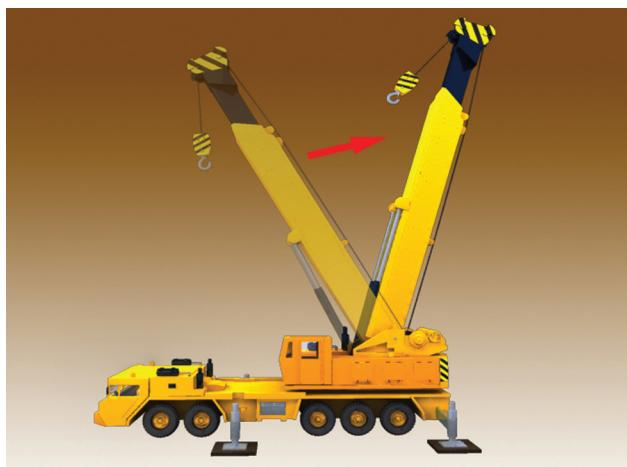
**①**起重機械在不同的吊臂角度(即吊臂與水平線所成的角度)下操作時，會有不同的安全操作負荷，吊重時必須依照製造商的指引與及合資格檢驗員檢驗員檢驗和測試的決定。
