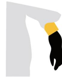
3 防護衣袖口需覆蓋在白色 4hr 防酸鹼手套上，將黑色手套套在第二層，最後在防酸鹼手套與防護衣間縫處黏上抗化膠帶。
