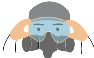
4 戴上防毒面具進行密合測試後，再戴上防護眼鏡，最後套上頭套。
