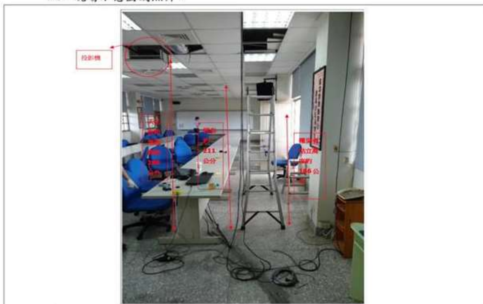
附照1 災害現場概況(天花板距地面高度約 288 公分、梯高約 211 公分、罹災者站立高度約 166 公分)
