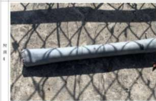
說明 第 6 層第 2 階斷裂之吊梯
